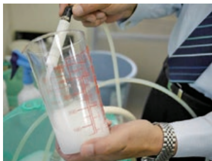
発生装置から出る白濁のお湯がマイクロバブル
