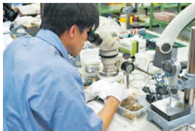
細かい部品が多いため、品質検査は顕微鏡を使用する
